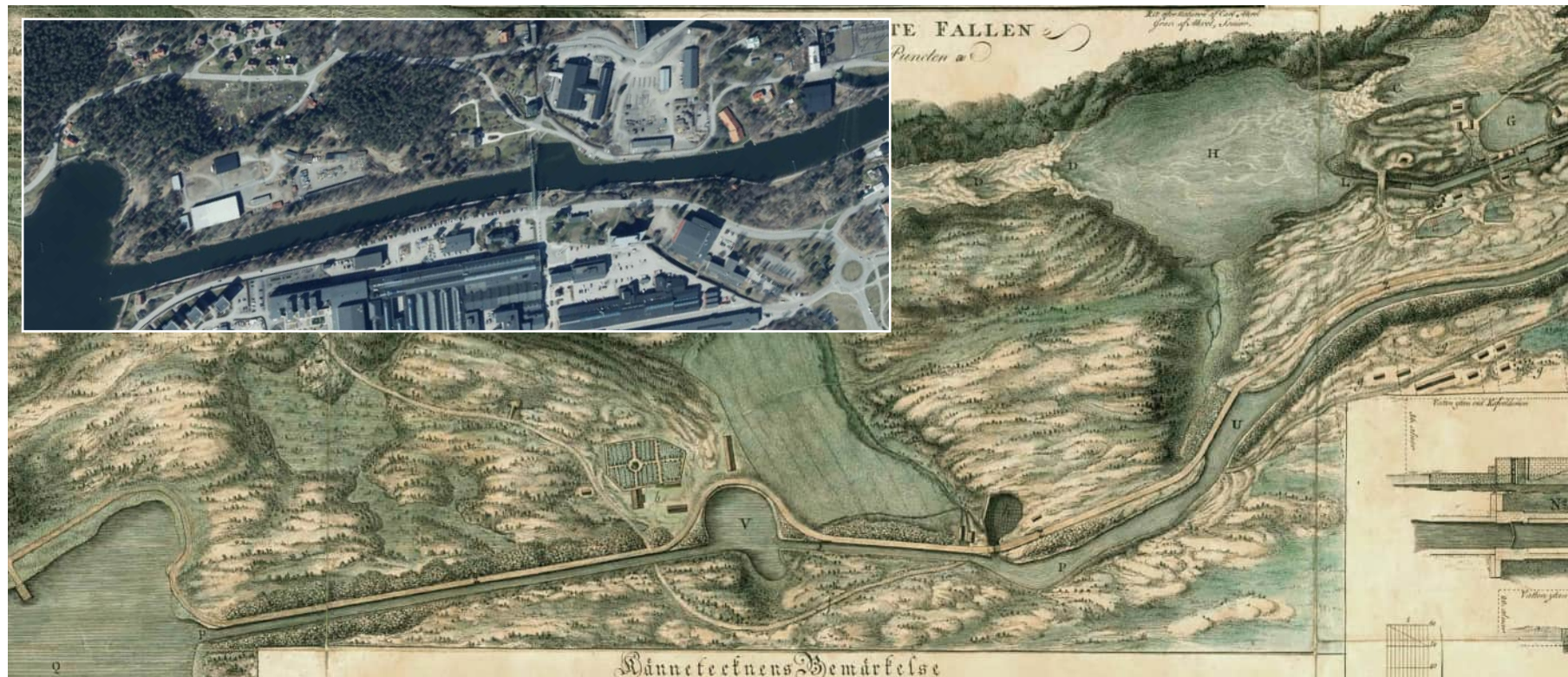
Figur 74. Södra delen av Bergskanalen, år 1800 (Krigsarkivet), med nutida ortofoto infällt. Kanalen har breddats men med bibehållen sträckning. Vissa strukturer som Olidebassängen och infart mot dockan finns kvar idag. Olidans gård med trädgård syns i båda illustrationer. Dockan byggdes om kring 1914 och är idag ersatt av en byggnad. Strukturer i kajen visar var den låg.
