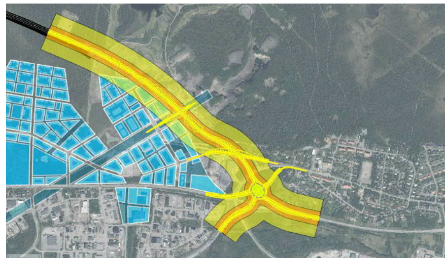
Figur 6-7. Skyddsavstånd för vägalternativ F. Skyddsavståndet gäller till transportled för farligt gods på ort med gruvdrift. Orange färg visar skyddsavståndet 40 meter, gul färg visar skyddsavståndet 120 meter.
