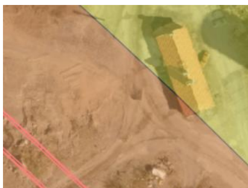
Figur 5. Byggnad på TGA-området vars hörn hamnar inom skyddsavståndet 40 meter. E10 syns till vänster i bild.
