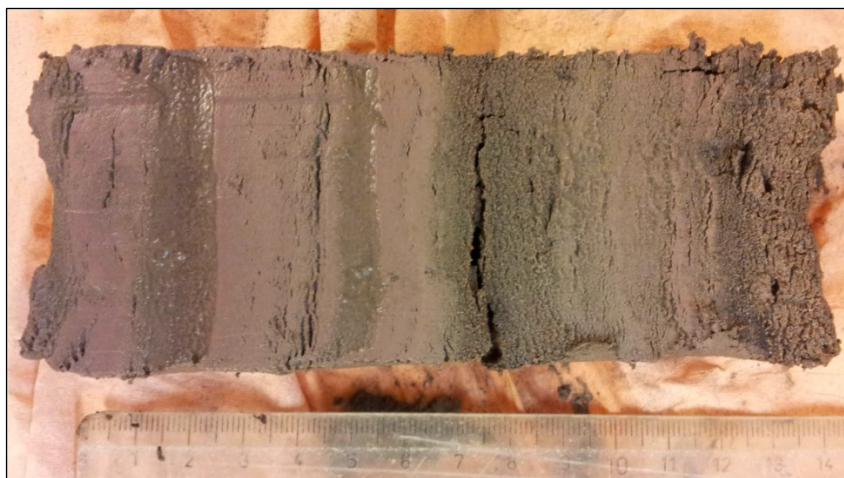
Figur 3 Genomsnitt av kolvprov från sandmagasinet, foto MRM
