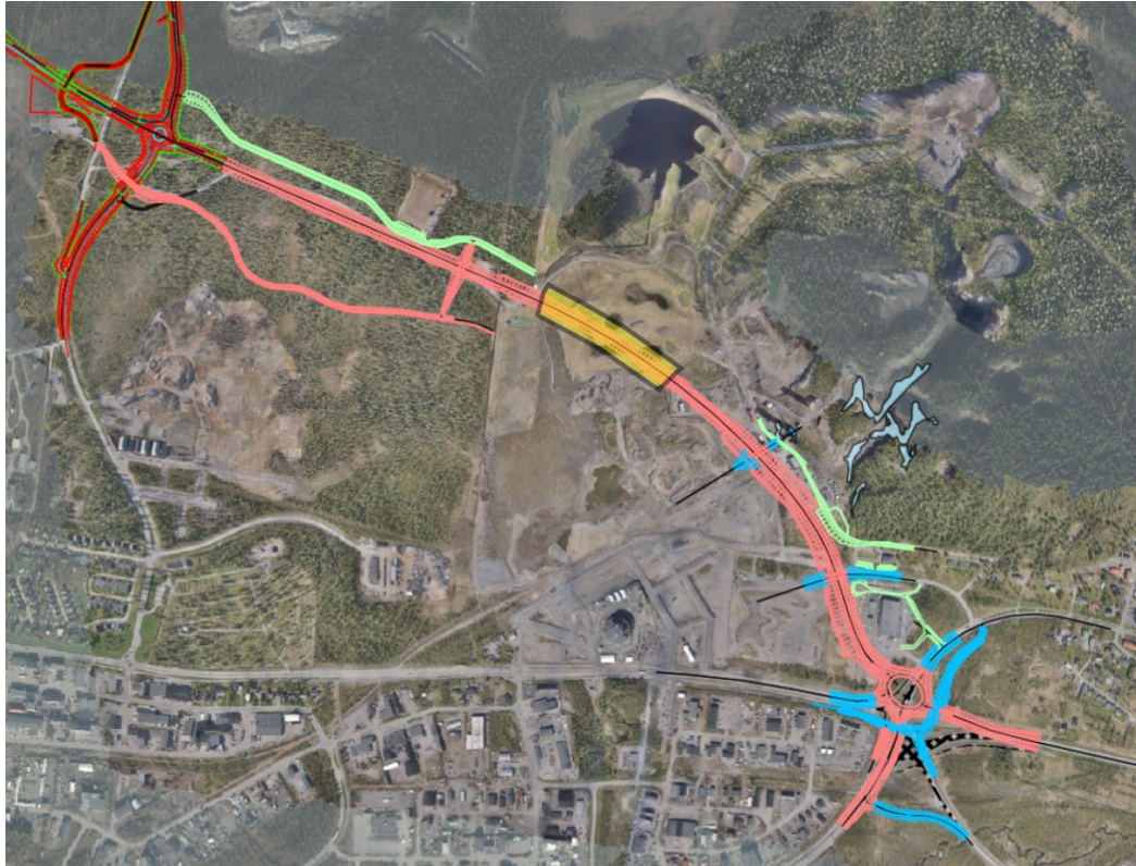
Figur 10 Gul markering är område med sättningsbenägen mark där sättningsreducerande åtgärder i form av överlast föreslås.
