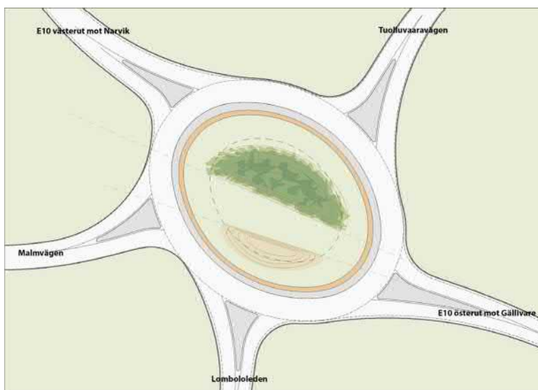
Figur 4.3-3 Föreslagen oval cirkulationsplats med fem ben
