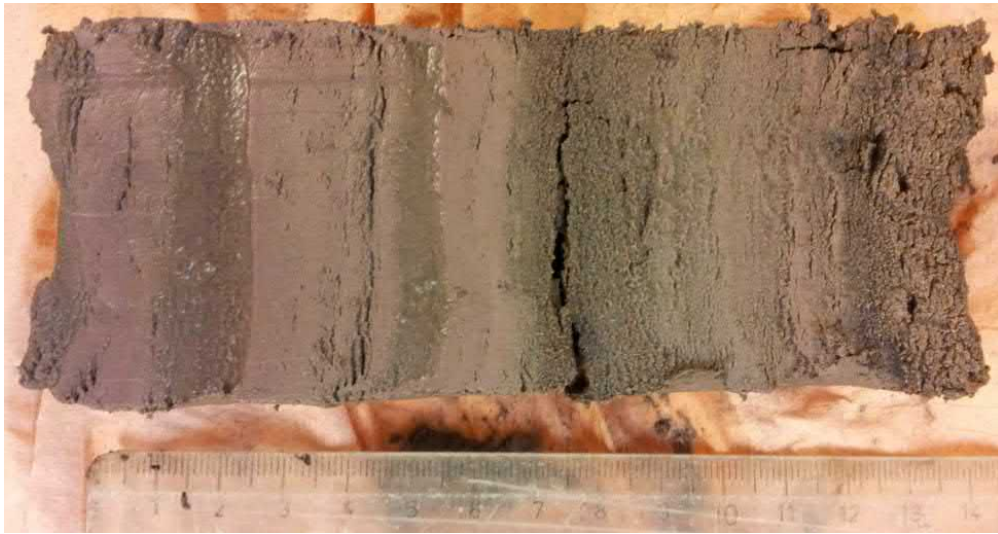
Figur 3.7-2 Genomskärning av kolvprov från sandmagasinet. Jorden är skiktad och består till stor del av finkorniga jordarter som lera och silt
