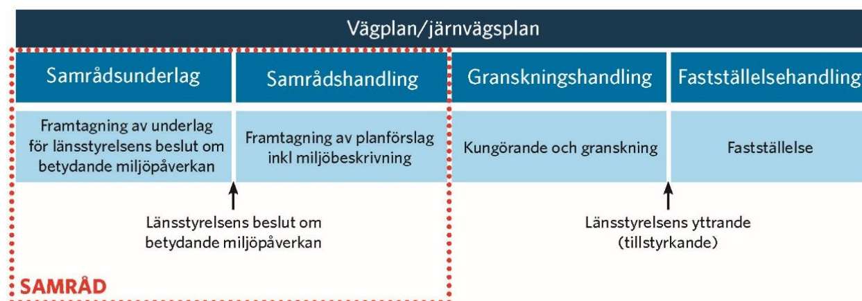
Figur 4. Schemat visar de olika formella stegen i planeringen av vägen.
