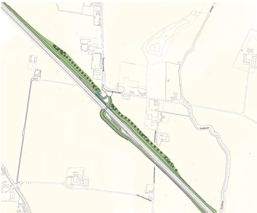
Figur 15 - Illustration över den föreslagna bullerskyddsvallens och skärmarnas utsträckning på den nordöstra sidan om väg 108 vid Knästorp. Skärmarna illustreras med blå linjer.
