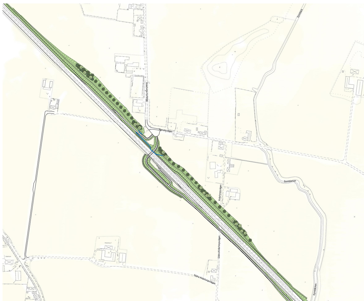
Figur 4.3.2:1 Illustration över den föreslagna bullerskyddsvallens och skärmarnas utsträckning på den nordöstra sidan om väg 108 vid Knästorp. Skärmarna illustreras med blå linjer.
