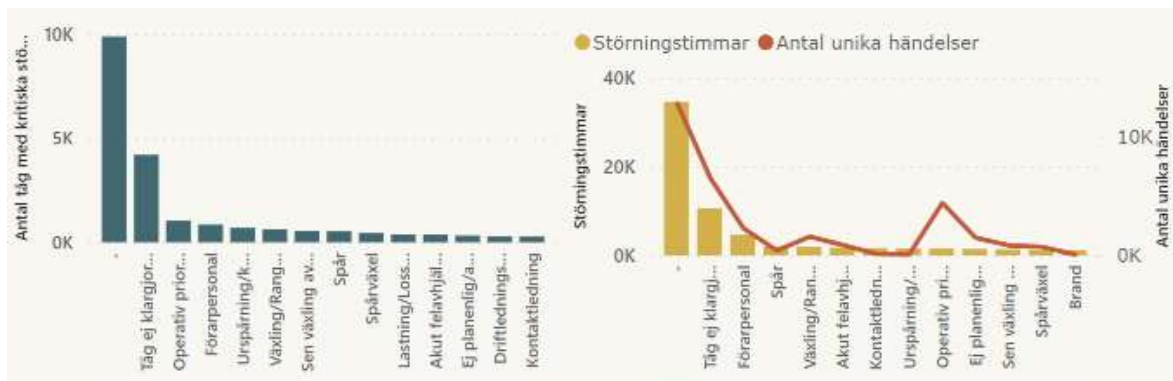
Figur 9 Utfall i antal tåg med kritiska störningar och antal störningshändelser samt störningstimmar (merförseningstimmar) för de opunktliga godstågen (RT+15) fördelat på Nivå 3 under 2023
