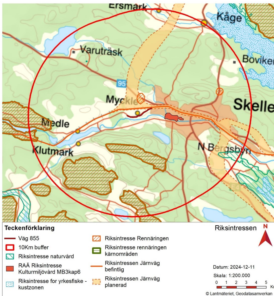
Figur 6. Områden av riksintresse inom en radie av 10 km runt området för vägplanen.
