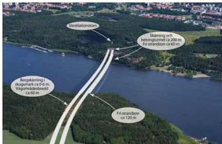
Figur 9.1.10 Bro över Lambarfjärden. Delade broar. Höjd 26 meter.
