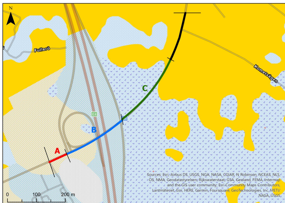
Figur 33. Konfliktsträckor A–C för den fördjupade riskanalysen baserat på ÅDT och jordarternas egenskaper. Den svarta delen av väg 290 (0/620 – 0/890) bedömdes som riskklass 2 i den översiktliga riskanalysen (tidigare benämnd sträcka C) och analyseras därmed inte vidare. SGU:s Jordartskarta är bakgrundskarta.
