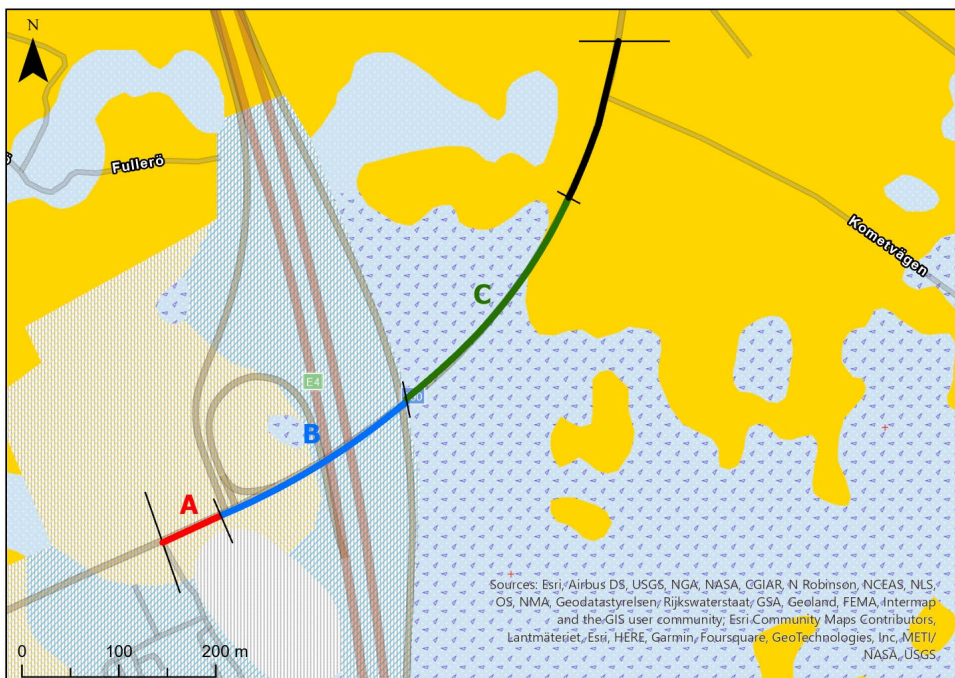
Figur 33. Konfliktsträckor A–C för den fördjupade riskanalysen baserat på ÅDT och jordarternas egenskaper. Den svarta delen av väg 290 (o/620 – o/890) bedömdes som riskklass 2 i den översiktliga riskanalysen (tidigare benämnd sträcka C) och analyseras därmed inte vidare. SGU:s Jordartskarta är bakgrundskarta.
