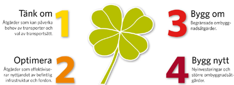
Figur 3. Schematisk illustration över fyrstegsprincipen. Källa: Trafikverket.
