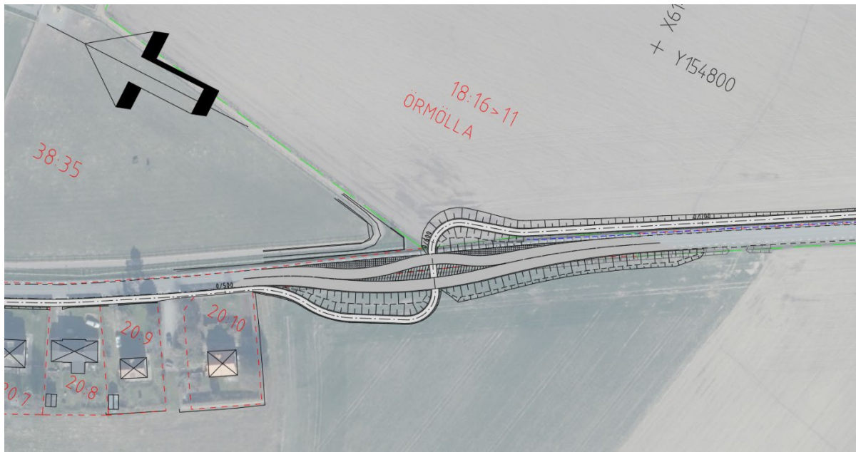
Figur 28. Tätortsport på väg 734 söder om Skivarp.
