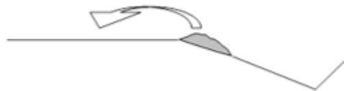
Figur 13 Indragning av material från slänt till vägbana
