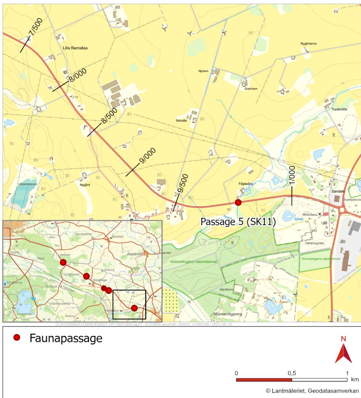
Figur 56. Skyddsåtgärd för vilt på väg 11 Anklam–Tomelilla – passage 5.
