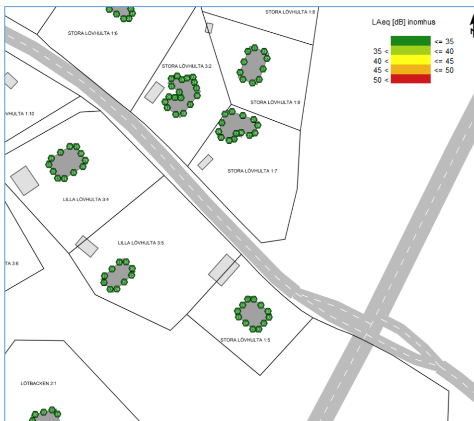
Figur 13. Beräknade ekvivalenta ljudnivåer inomhus (utomhusljudnivå vid fasad som frifältsvärde minus 27 dBA), nuläge 2018.
