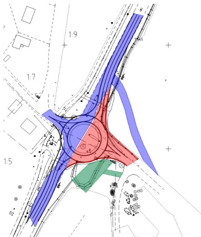
Figur 11. Föreslagen trafikomläggning under skede 1 i byggskedet. Grönt område är yta för upplag.
