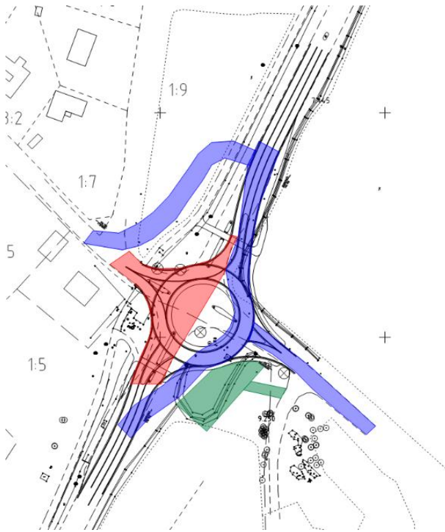
Figur 12. Föreslagen trafikomläggning under skede 2 i byggskedet. Grönt område är yta för upplag.
