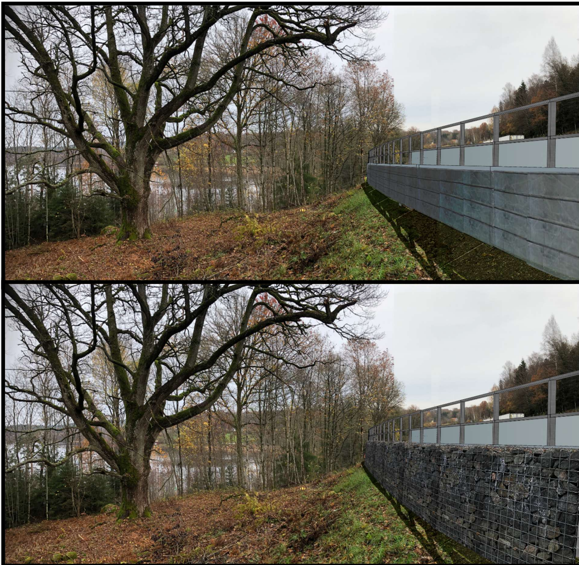
Figur 34. För att minska markintrånget kompletteras slänterna med en 1–3 meter hög stödmur. I övre bild illustreras en stödmur i gjuten betong. I nedre bild illustreras en stödmur med stenmaterial. Naturmarken är svårtillgänglig och slyartad men det finns även naturvärden med stora karakteristiska ekar. Fotocollage: Mika Määttä, AFRY
