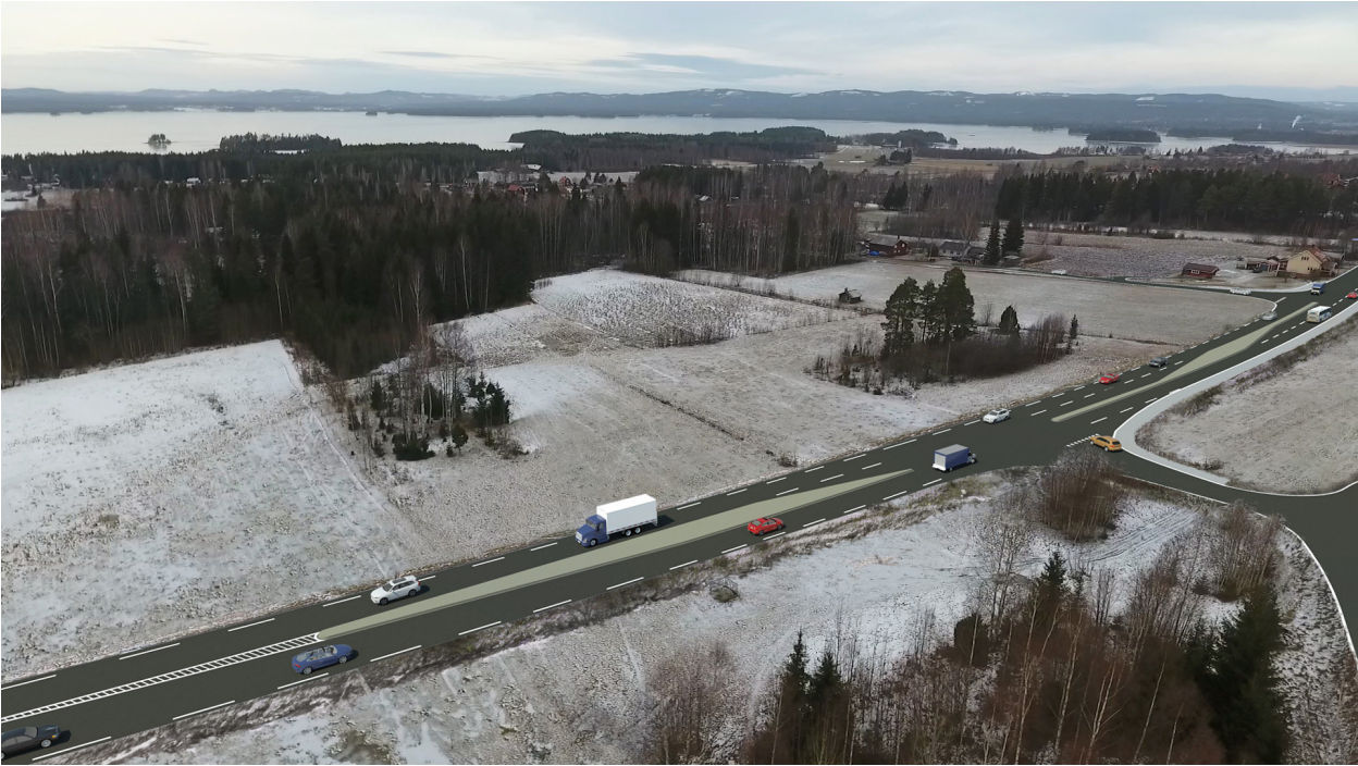
Där delsträcka 1 ansluter till befintlig väg genom Holen föreslås refuger för att dämpa hastigheten och öka säkerheten i korsningar.
