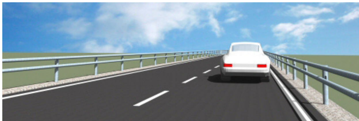
Exempel på sidoräcke vid exempelvis hög bank.
