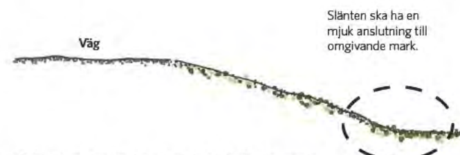
Figur 5 Slänter ska anslutas mjukt till befintlig mark.
