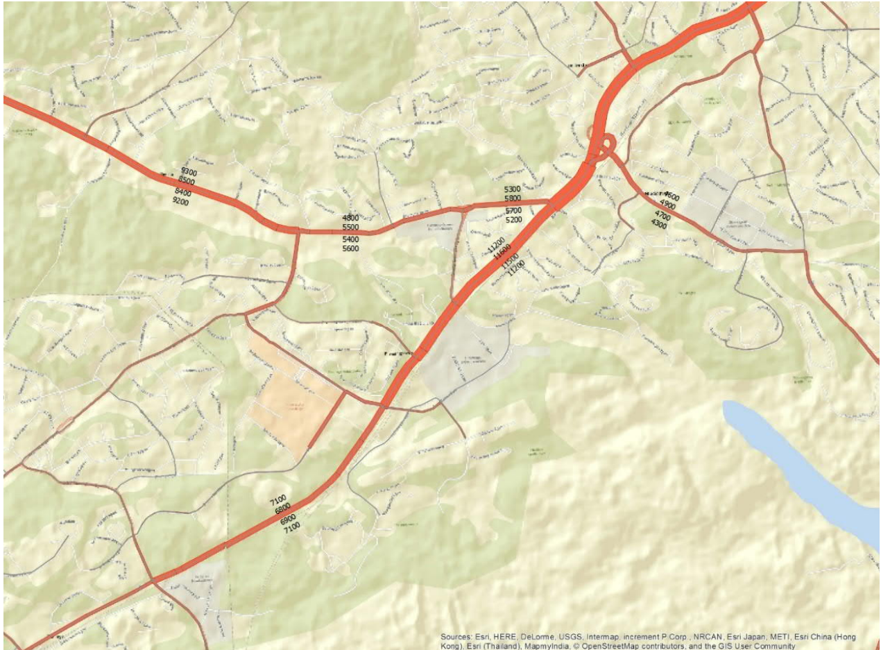
Figur x: Jmf modellgenererade flöden och trafikmätningar (ÅMD, personbil), modell innerst, trafikdata ytterst, efter kalibrering
