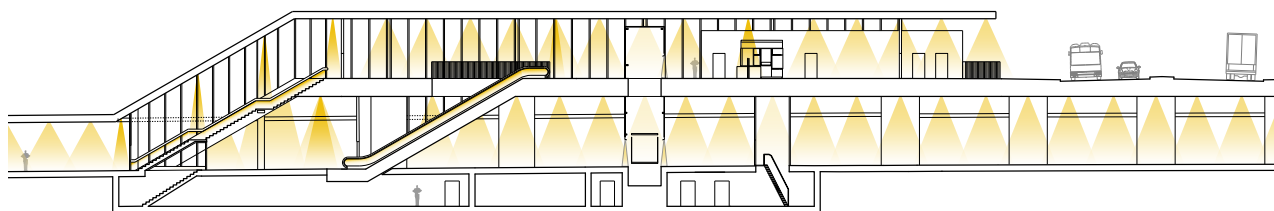
Huvudsta station - Belysning av biljetthallen och underliggande plattform
