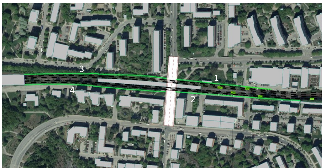
Figur 5. Bullerskyddsskärmar i Huvudsta. De gröna linjerna motsvarar nya bullerskyddsskärmar som utvärderats i utredningen. Bullerskyddsskärmarna ansluts tätt mot teknikhus de ligger i anslutning till för att få ett kontinuerligt bullerskydd. Växlar visas som gröna rektanglar på spåren. Siffrorna 1-4 anger numrering av bullerskyddsskärmarna som hänvisas till i avsnitt 7.3.
