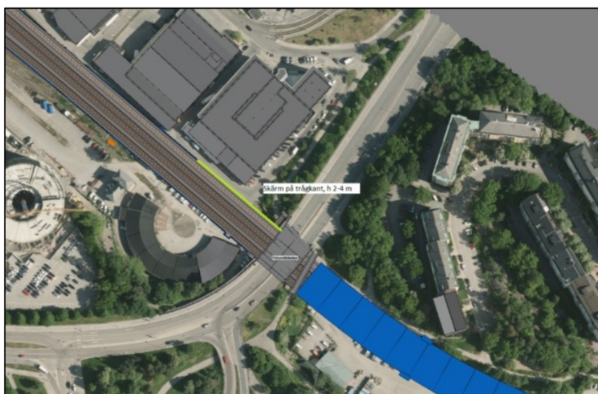
Figur 10. Grön linje visar bullerskyddsskärm på tråγκant vid Frösundaleden som utvärderats. Detta skärmlalternativ beräknas inte vara effektivt för att minska buller från Mälarbanan.
