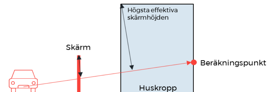
Figur 3. Beräkningsmodellen för buller tar bara hänsyn till ett skärmande objekt. Om en beräkningspunkt t.ex. befinner sig bakom en hög byggnad sett från bullerkällan kommer skärmen vid längs med vägen/järnvägen inte inkluderas i beräkningen, då dess effektiva skärmhöjd är lägre än byggnadens. Därmed överskattas bullernivån på t.ex. uteplatser som befinner sig på skyddad sida. Källa: FUD Kvalitetssäkring av bullerberäkningar, Trafikverket, 2018-10-10.
