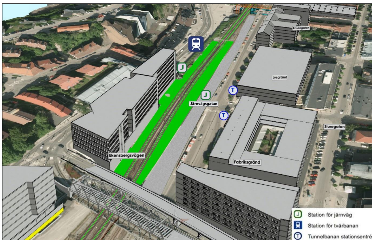
Figur 11. Stationslösning för pendel- och regionaltåg när den tillfälliga järnvägsanläggningen är i drift. Grön markering visar plattformarnas placering. Det är tunnelbanans södra entré som visas i figuren.
