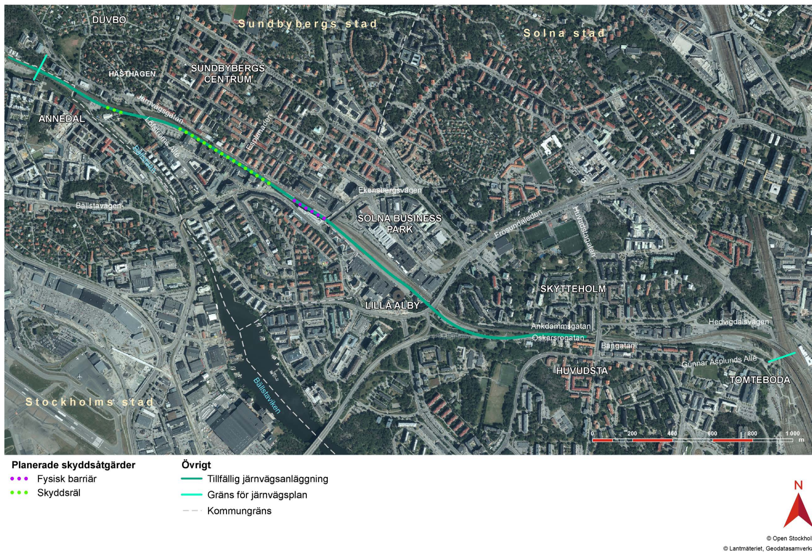
Figur 35. Översiktlig karta som visar placering av skyddsåtgärder mot tågrusspärning utmed den tillfälliga järnvägsanläggningen.
