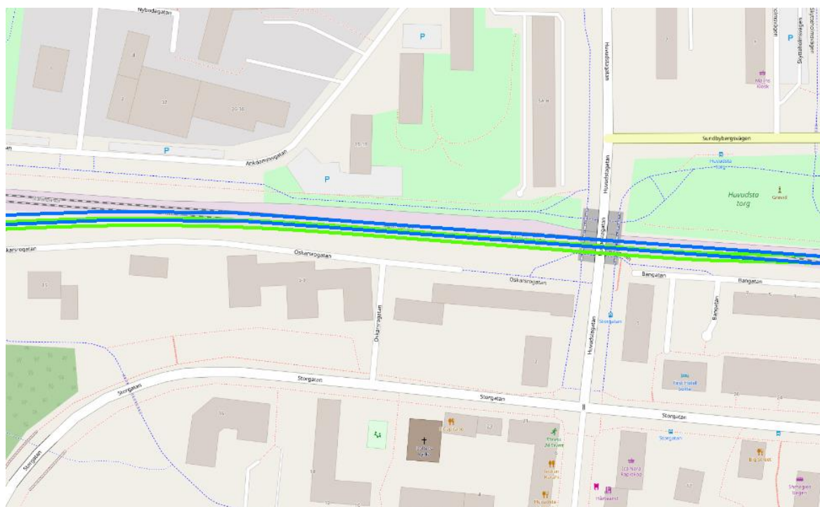
Figur 11 Placeringen av det tidigare och det ändrade tillfälliga spåret i Huvudsta. Blå – det tidigare tillfälliga spåret. Grönt – det nya tillfälliga spåret.
