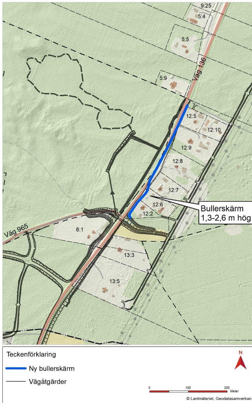
Figur 40 Vagnära bullerskyddsåtgärder. Höjd anger höjden över vägmitt.
