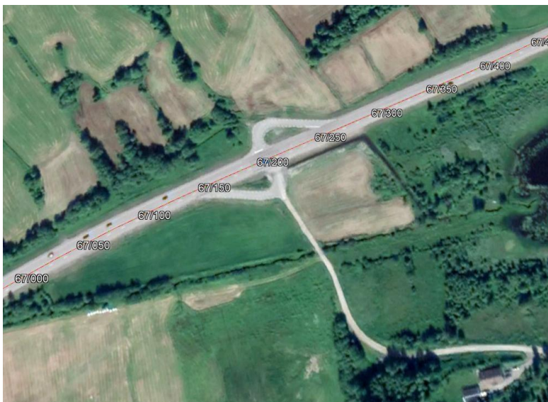
Bild 17. Visar korsning E4/Sörantjärn med två spanska svängar som kan användas som permanent anslutning till Kammartjärn.
