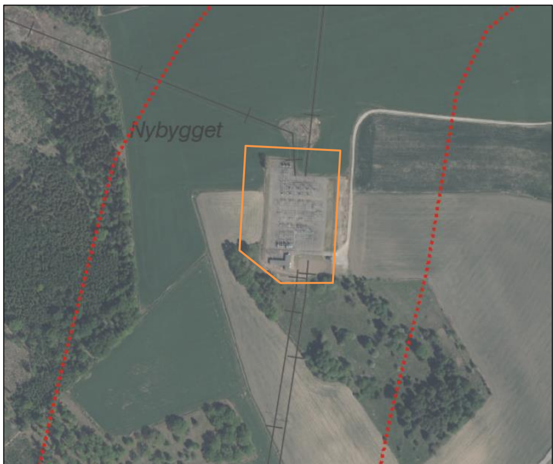
Figur 3. Tekniska Verkens ställverk som finns inom utredningsområdet (fastighet Himna 11:229), fastighetens gränser illustreras med orange.
