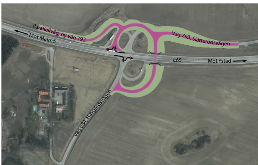
Figur 17. Utformningsexempel med port under väg E65
