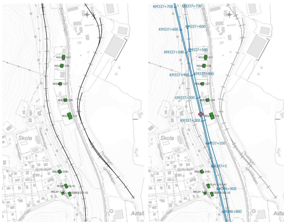
Figur 11 Kartbild över område i Svartvik/Hemmanet. Nuläge/nollalternativ till vänster och planförslag till höger. Beräknad vibrationsnivå i bostadsbyggnader markeras med färg: grönt <0,4 mm/s vägd RMS. I planförslaget markerar rosa diamant broar över Serpentinvägen.
