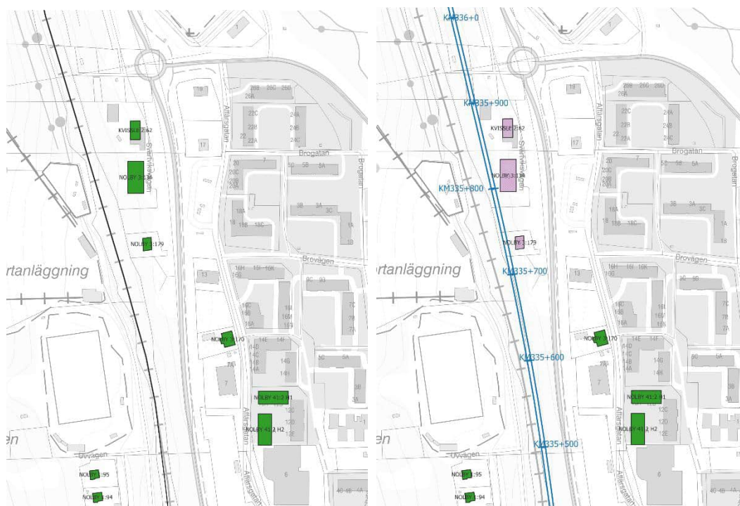
Figur 10 Kartbild över område i Kvissleby. Nuläge/nollalternativ till vänster och planförslag till höger. Beräknad vibrationsnivå i bostadsbyggnader markeras med färg: grönt <0,4 mm/s vägd RMS. I planförslaget markerar lila färg inlösta byggnader.
