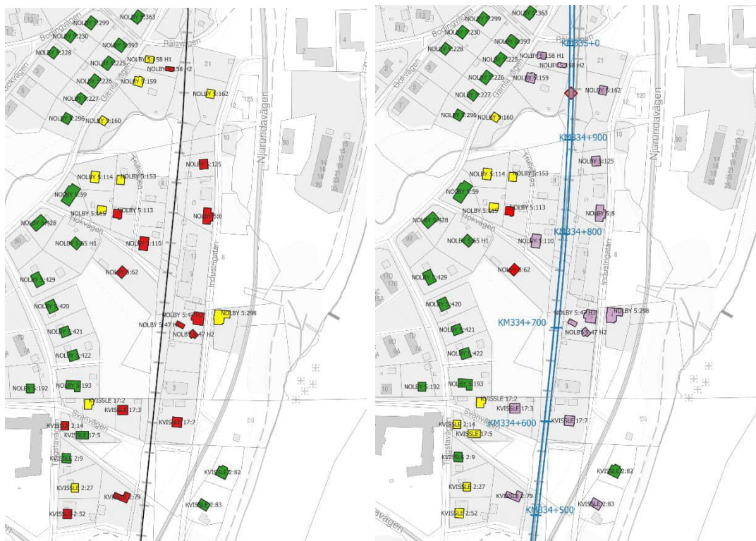
Figur 8 Kartbild över område i Nolby. Nuläge/nollalternativ till vänster och planförslag till höger. Beräknad vibrationsnivå i bostadsbyggnader markeras med färg: rött >0,7 mm/s, gult 0,4 mm/s-0,7 mm/s och grönt <0,4 mm/s. I planförslaget markerar rosa diamant bro över Rålsvägen och lila färg inlöst byggnader.
