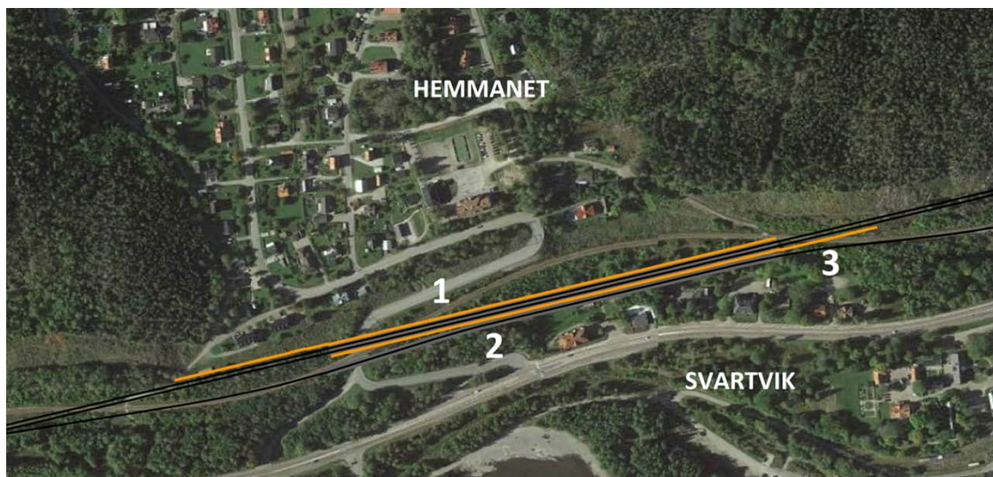
Figur 11 Illustration över föreslagen källnära åtgärd för Svartvik/Hemmanet. Orange markering visar bullerskyddsskärm.
