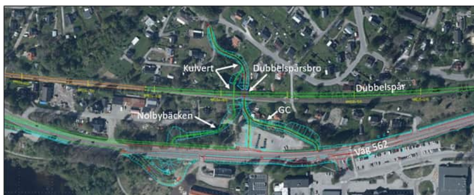
Figur 4.7:5 Avfört alternativ. Innebär att Nolbybäcken behöver kulverteras på två platser, vilket inte är i linje med ambitionen att "öppna upp" så mycket som möjligt av bäcken.
