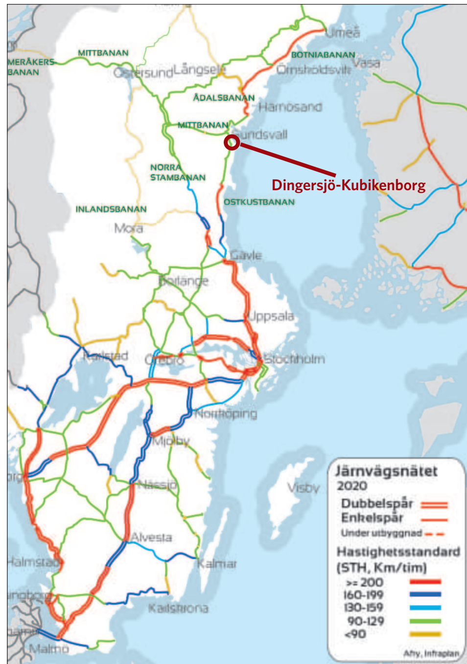
Figur 3.1:2 Ostkustbanan är enkelspårig och har delvis låg hastighetsstandard och bristande kapacitet.
