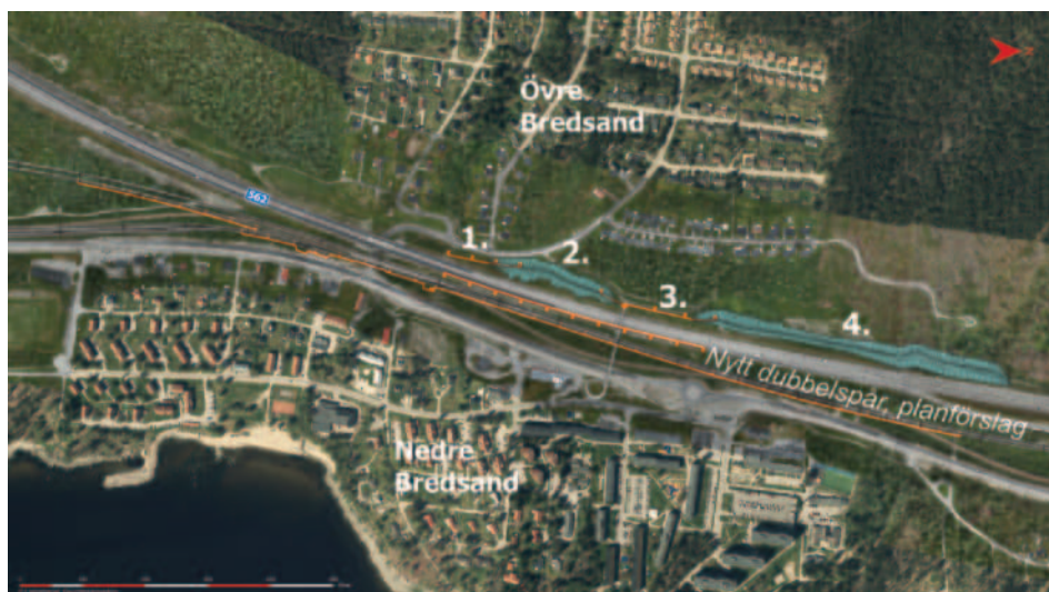
Figur 4.8:4 Illustration över föreslagna källnära åtgärder för Övre Bredsand. Orange markering visar bullerskyddsskärm, blå markering visar bullerskyddsvall. Befintliga bullersskyddsskärmar och -vallar redovisas inte i illustrationen.
