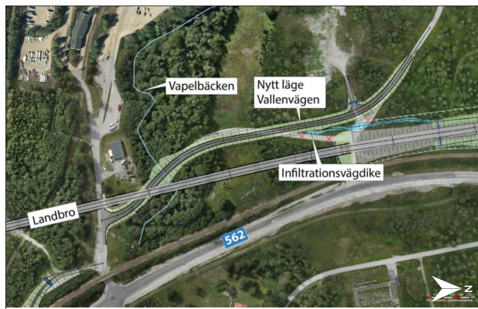
Figur 4.2:31 Översikt över hur bron avvattnas via infiltrationsdike längs Vallenvägen innan anslutning sker till Vapelbäcken.
