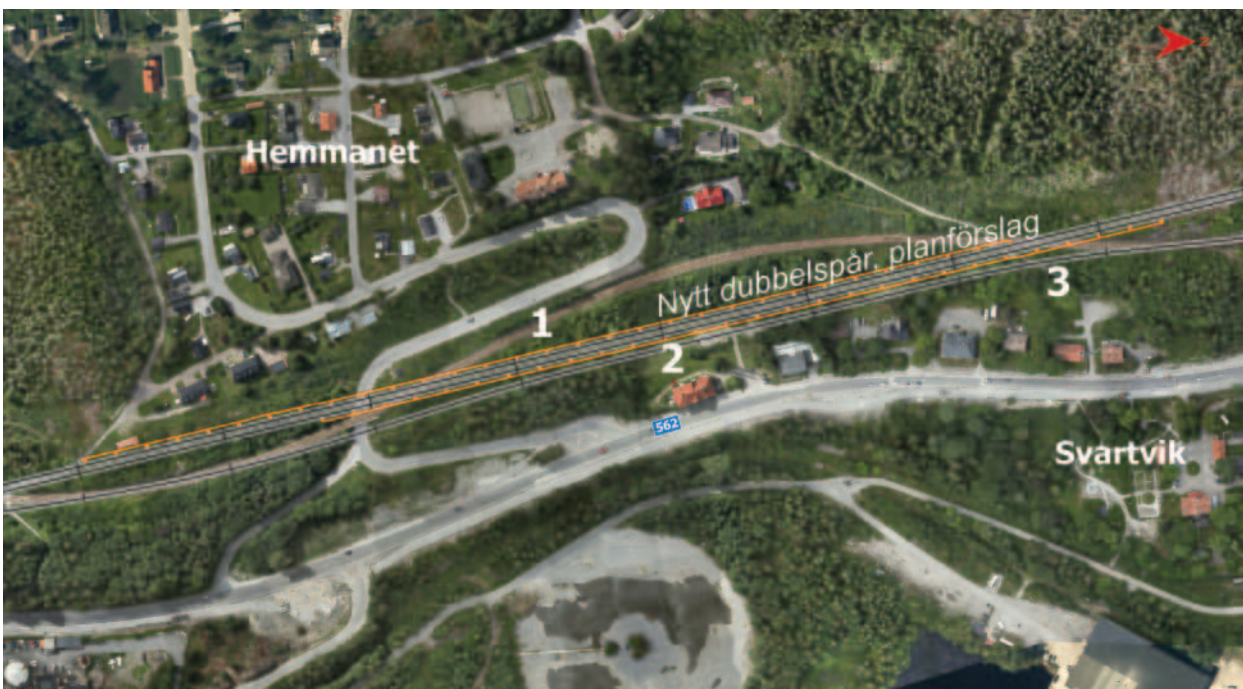
Figur 4.8:3 Illustration över föreslagen källnära åtgärd för Svartvik/Hemmanet. Orange markering visar bullerskyddsskärm.
