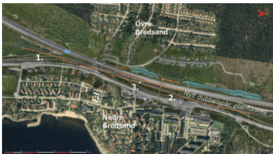
Figur 4.8:5 Karta över föreslagna källnära åtgärder för Nedre Bredsand. Orange markering visar bullerskyddsskärm, blå markering visar bullerskyddsvall. Befintliga bullersskyddsskärmar och -vallar redovisas inte i illustrationen.
