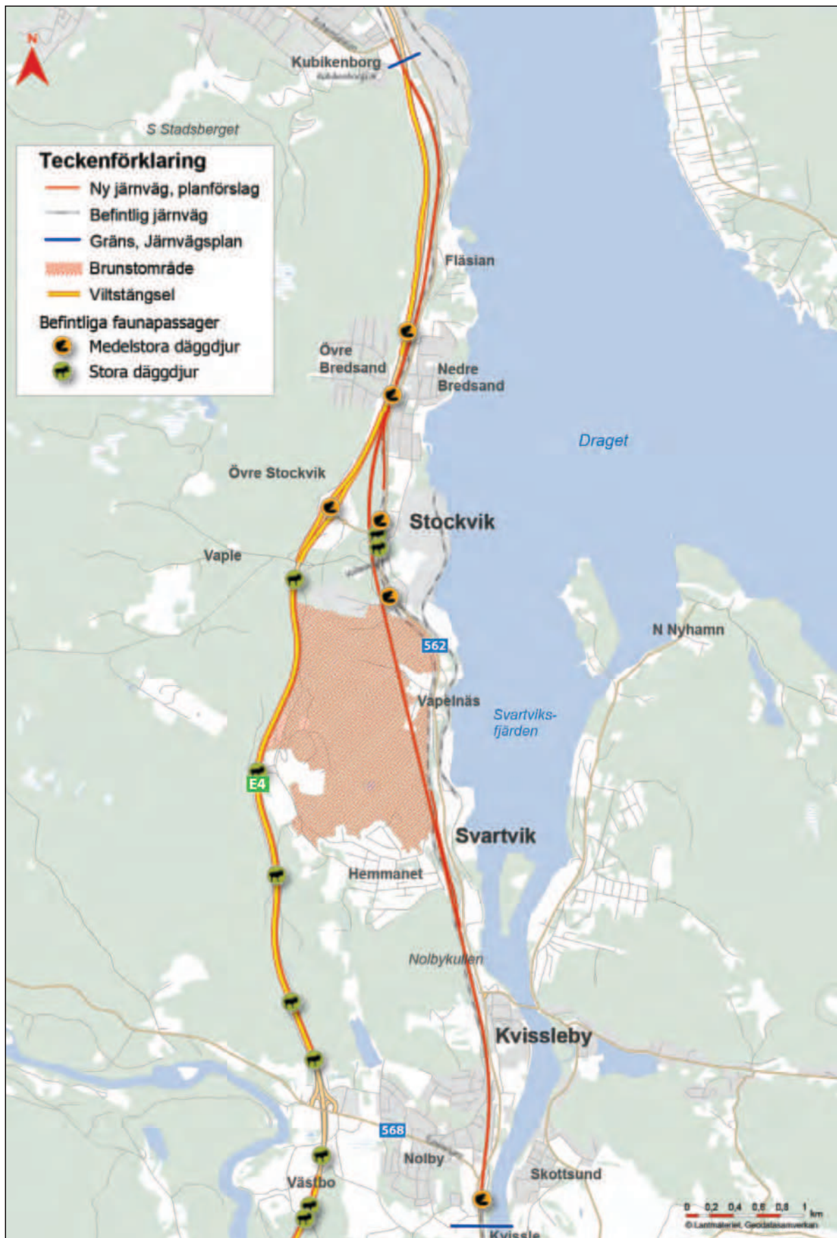
Figur 8.3:3 Befintliga barriärer och faunapassager.
