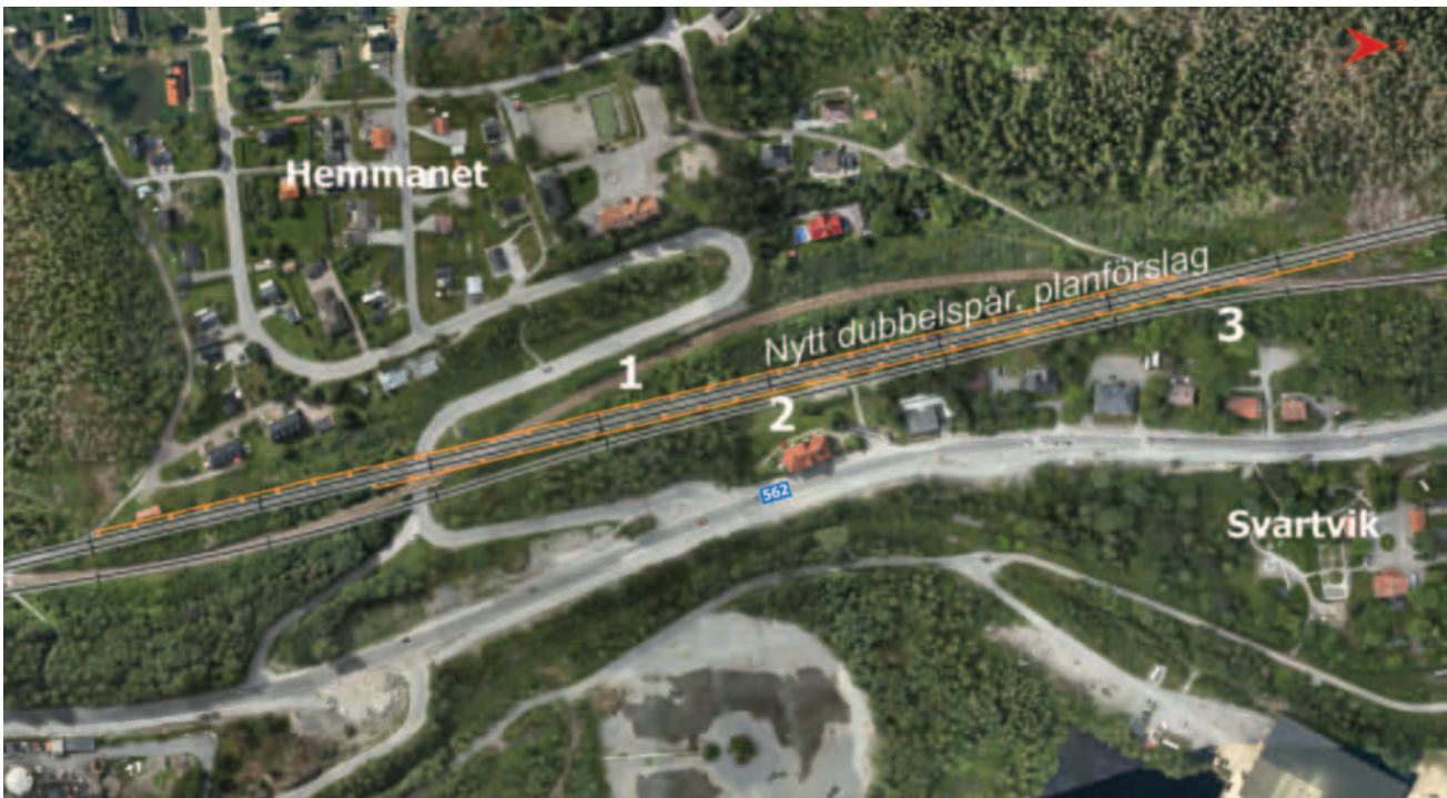
Figur 8.6:7 Illustration över föreslagen källnära åtgärd för Svartvik/Hemmanet. Orange markering visar bullerskyddsskärm.
