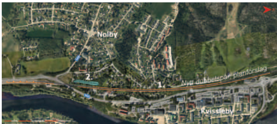
Figur 8.6:3 Illustration över föreslagna källnära åtgärder för Nolby. Orange markering visar bullerskyddsskärm, blå markering visar bullerskyddsvall.
