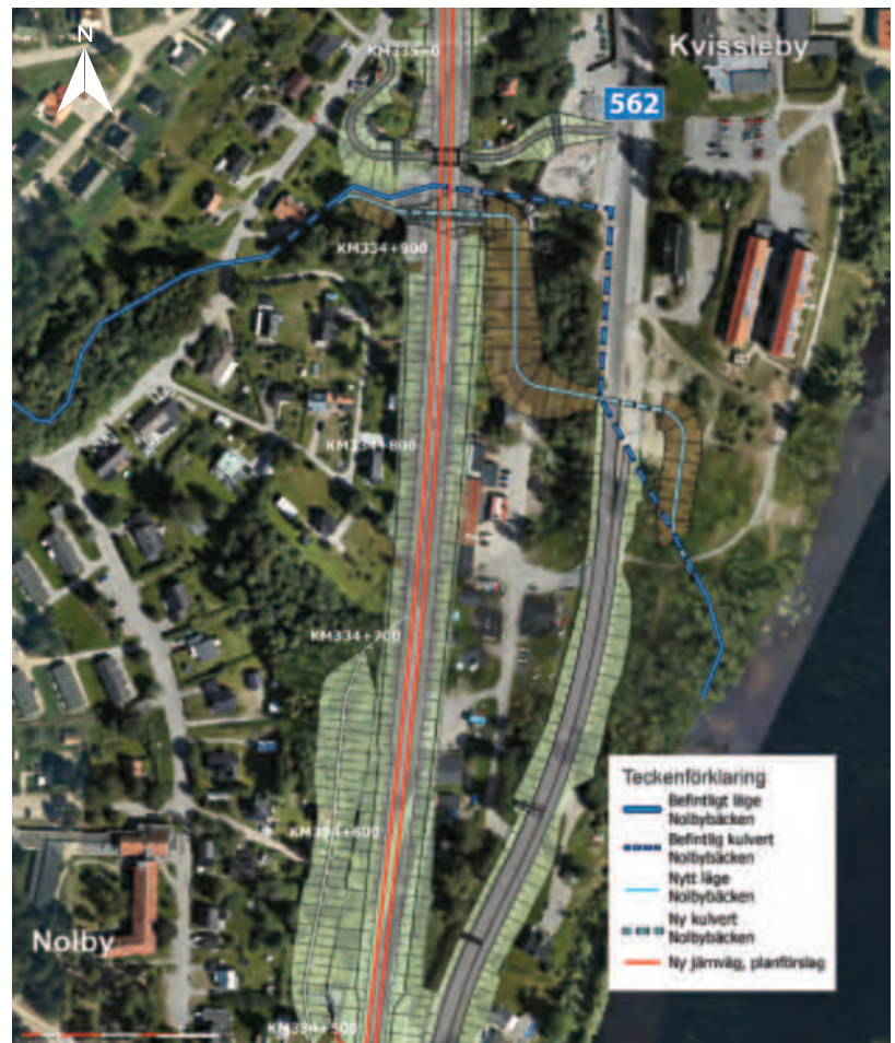
Figur 6.3:28 Befintlig och planerad omläggning av Nolbybäcken.
