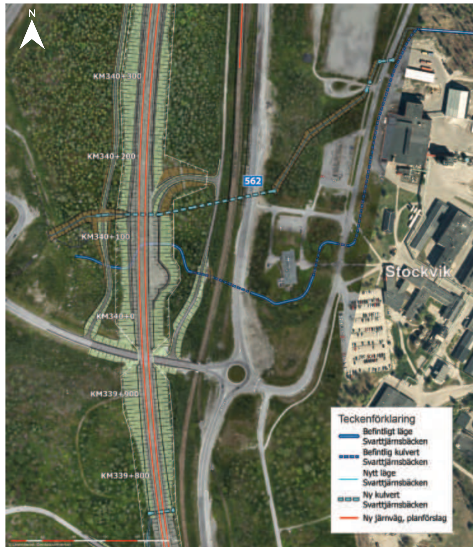
Figur 6.3:30 Befintlig och planerad omläggning av Svarttjärnsbäcken.
