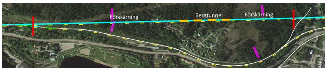
Figur 6. Alternativ Kortare bergtunnel. Alternativet med denna tunnel innebär ett lägre profilläge (dvs. bottennivån för anläggningen ligger djupare ner i marken), vilket innebär att förskärningarna blir djupare och får ett större släntutfall jämfört med alternativet Skärning.
