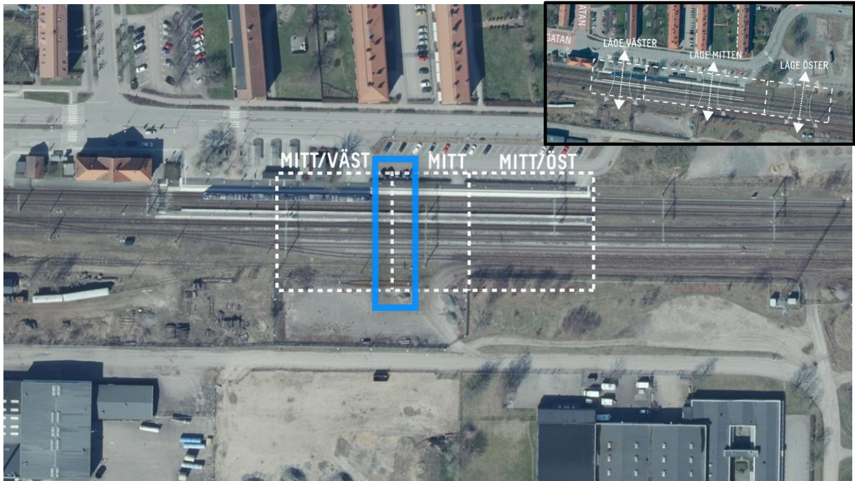
Figur 19. Studerade placeringar för gångbron där blå markering illustrerar vald placering. Infälld bild visar initiala lägen som studerats.
