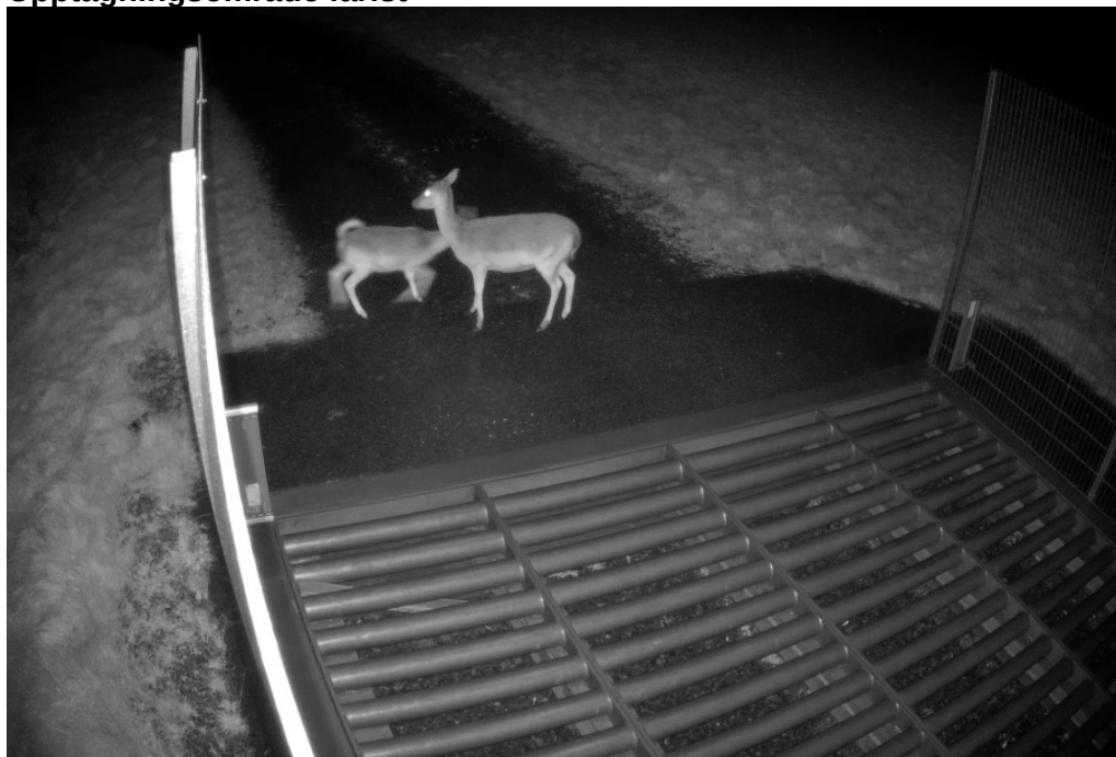
Figur 5. Bild som visar ungefärlig kameravy som behövs för att studera djurens nyttjande av färister. Kameran är riktad mot natursidan utanför färisten. Dessa dovhjortar står ungefär 1,5 meter från färisten. Liknande kamerauppsättning kan användas för de förstudier som planeras.
