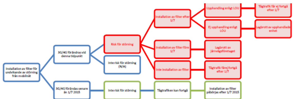
Figur 1, Konsekvensträd rörande installation av frekvensfilter
