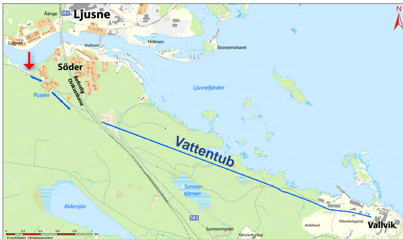
Figur 4.3:3 Vattentub till Vallviks bruk markerad med blå linje. Intagets ungefärliga läge markerat med röd pil.
