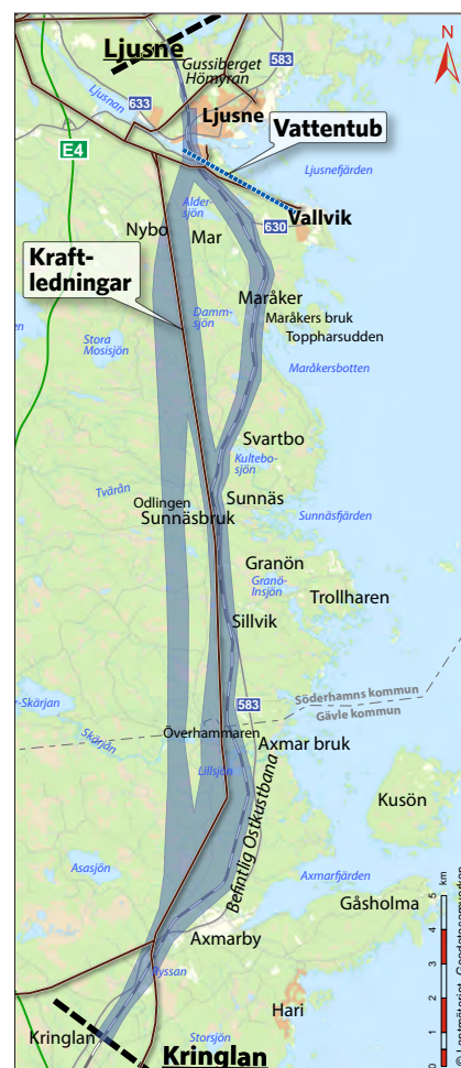
Figur 6.4:1 Större kraftledningar längs deletap-pen.
