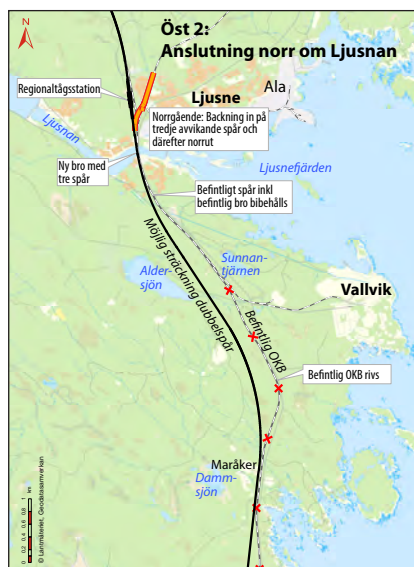
Figur 6.3:13 Exempelbild: Öst 2 med industrispårsanslutning norr om Ljusnan.
