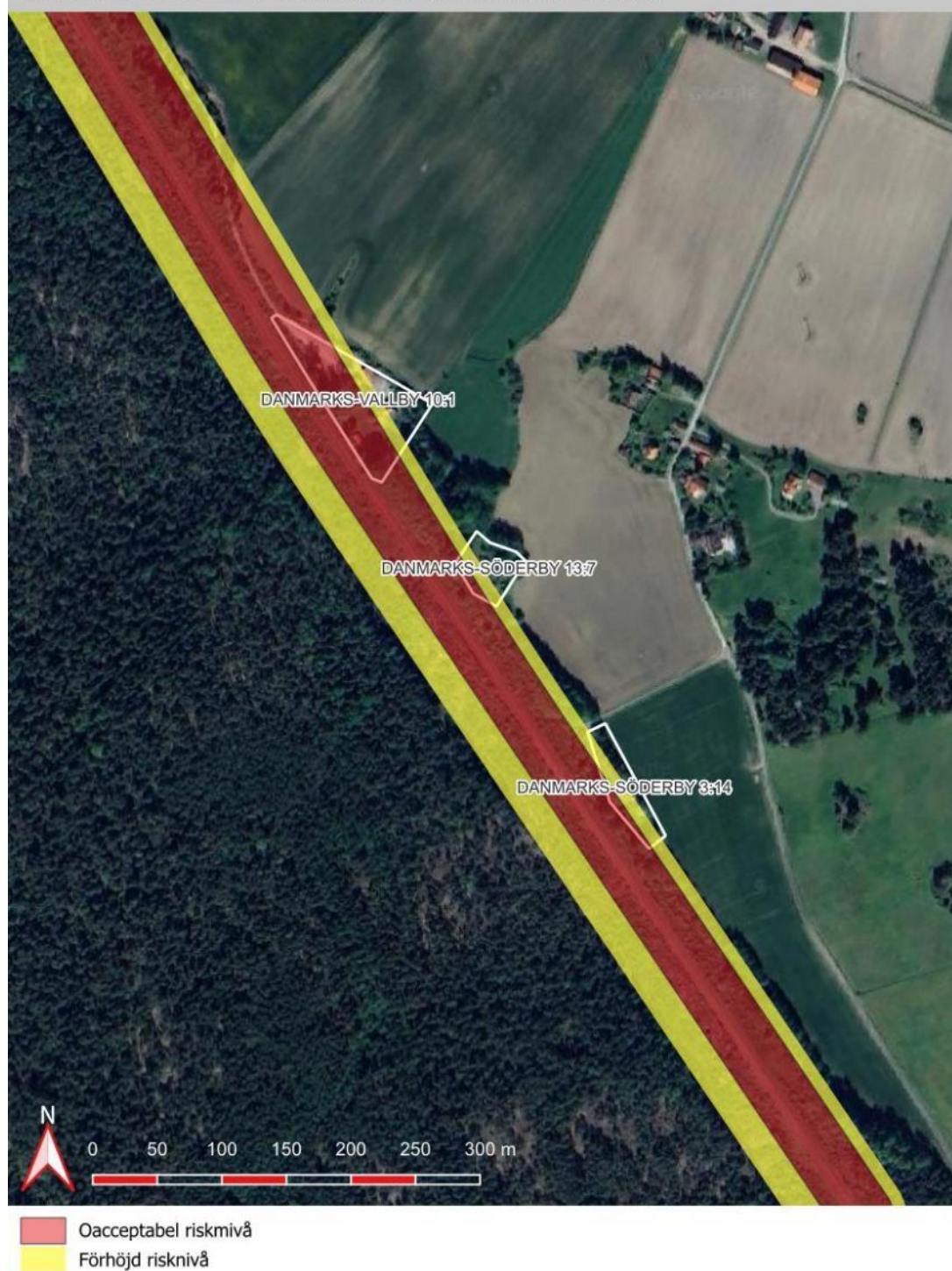
Figur 35. Område söder om Bergsbrunna med oacceptabel och förhöjd risknivå vid driftsatt, utbyggd anläggning.
