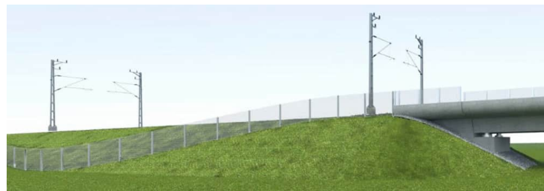
Figur 20. Typillustration, stängselövergång från bank till bro, stängslet övergår till ett förhöjt broräcke.
