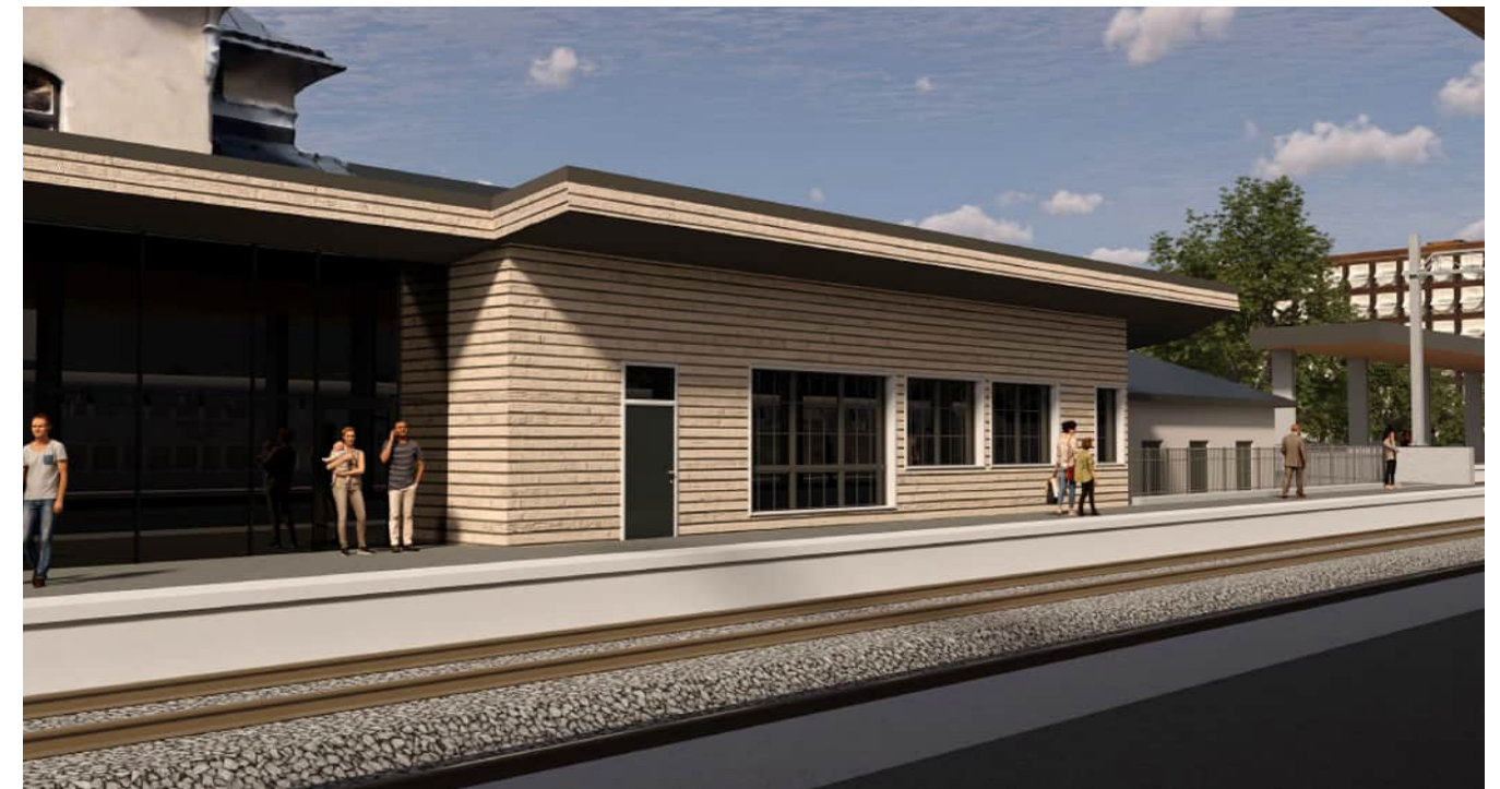
Figur 43. Visualisering som visar den förlängda plattformen vid spår 1 och den gamla godsexpeditionen med träfasad som utformas med ny sockel och justerad dörrplacering som anpassas till den nya plattformshöjden. Visualisering visar även anpassad nedre del av det större fönsterpartiet mitt på fasaden som utan anpassning skulle vara placerad under marknivån på den nya plattformen.
