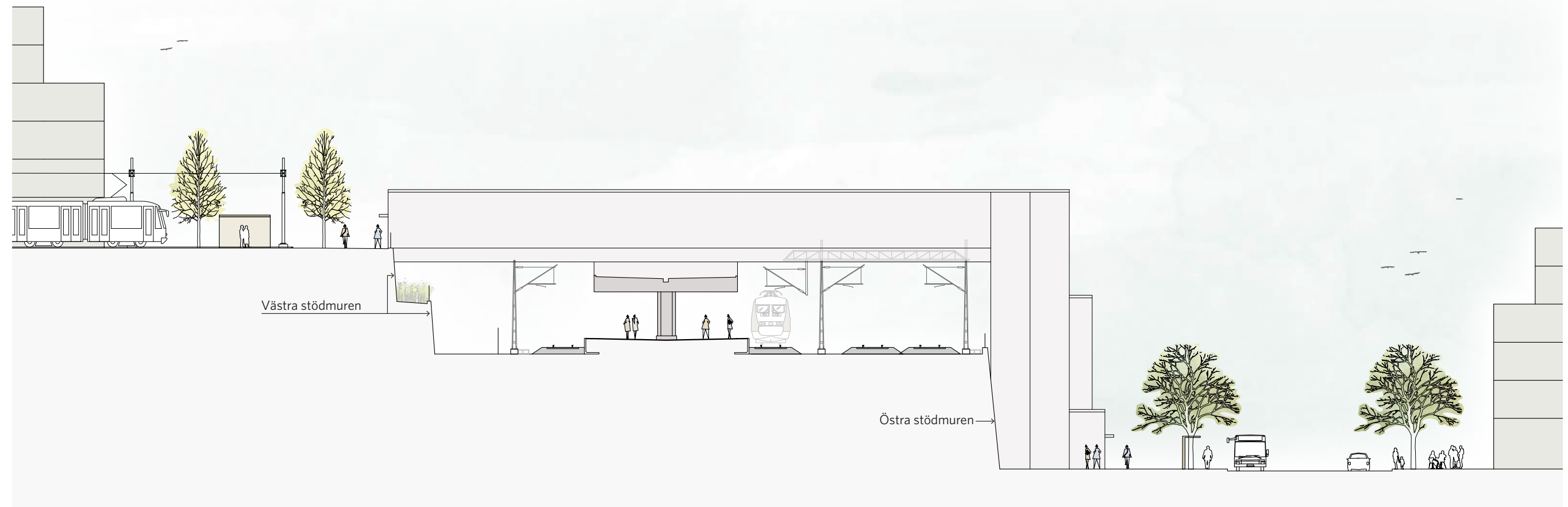
Figur 76. Sektion genom Uppsala södra som visar plattformsförbindelsen, stödmurar, spår, plattformstak och framtida bebyggelse.
