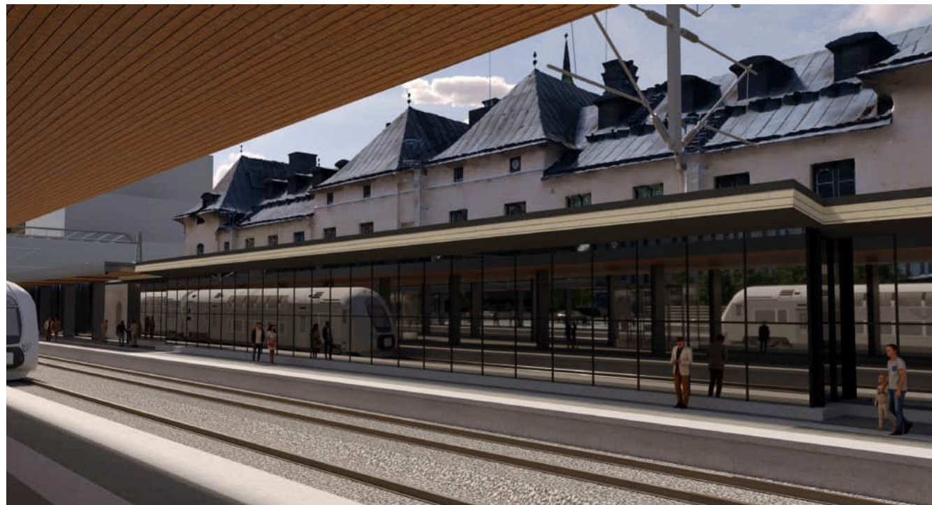
Figur 42. Visualisering som visar den förlängda plattformen vid spår 1 och stationshusets glasveranda som utformas med en ny sockel som anpassas till den nya plattformshöjden. Glasfasaden behålls i sitt befintliga läge för att minimera behovet av ingrepp i byggnaden.
