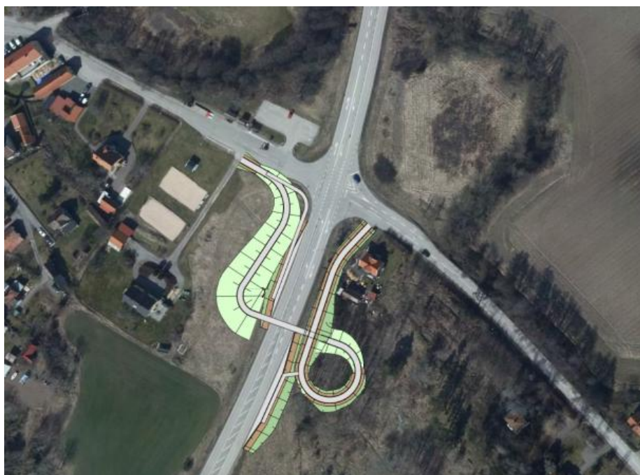
Figur 21. Principutformning för ny planskild gång- och cykelpassage enligt alternativ 3.
