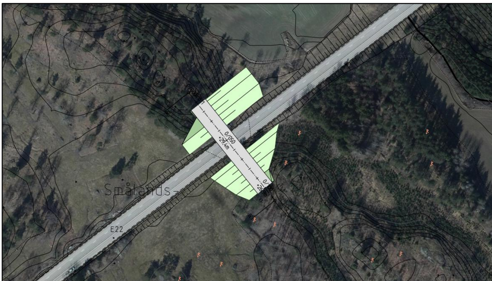
Figur 16. Utformningen för faunabro med lokalisering enligt alternativ 1.
