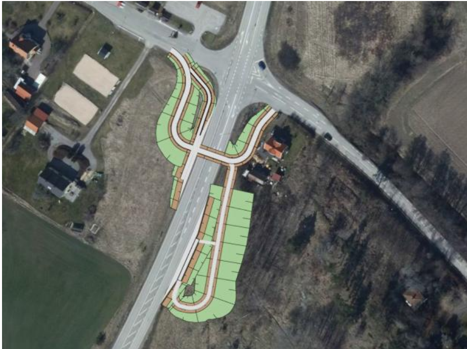
Figur 20. Principutformning för ny planskild gång- och cykelpassage enligt alternativ 2.
