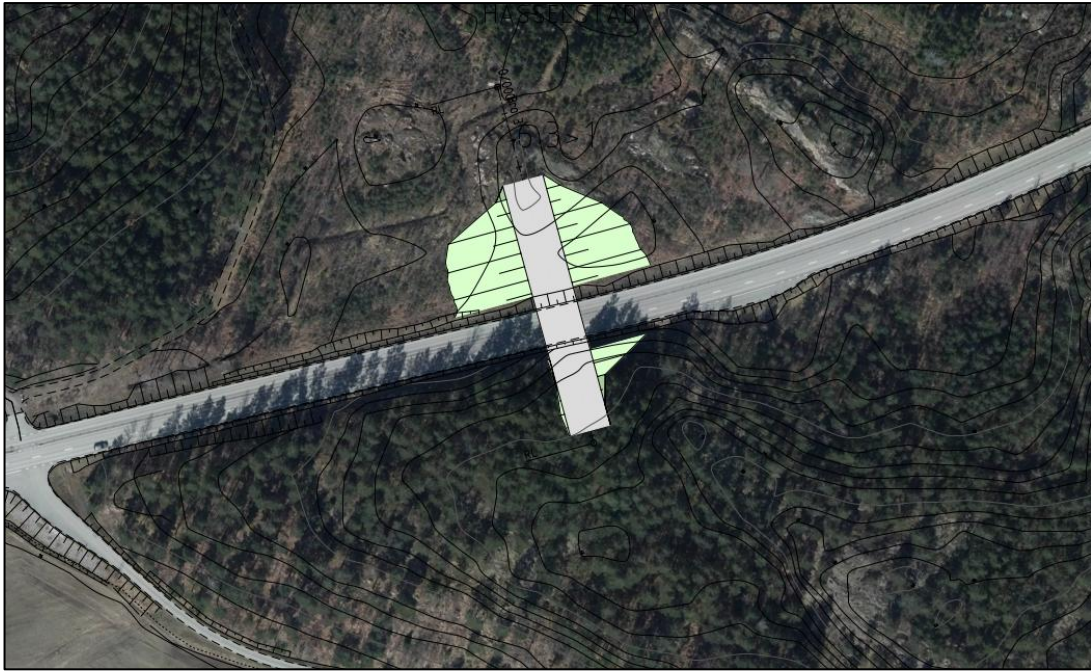
Figur 15. Utformning av faunabro med lokalisering enligt alternativ 3.
