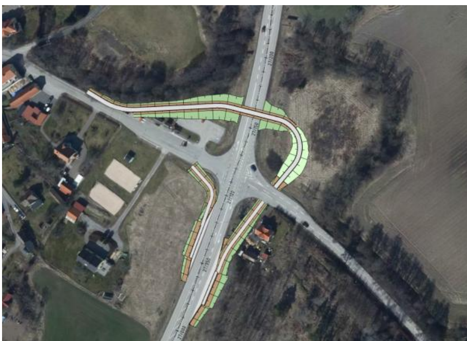
Figur 19. Principutformning för ny planskild gång- och cykelpassage enligt alternativ 1.
