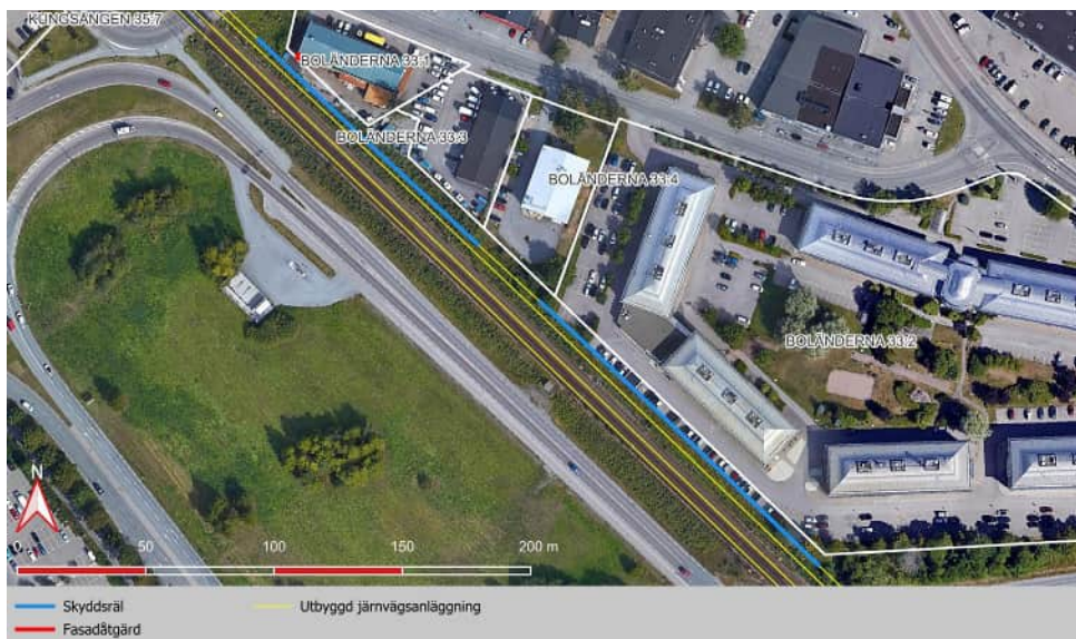
Figur 72. Planerade skyddsåtgärder för olycksrisk i Kungsängen.
