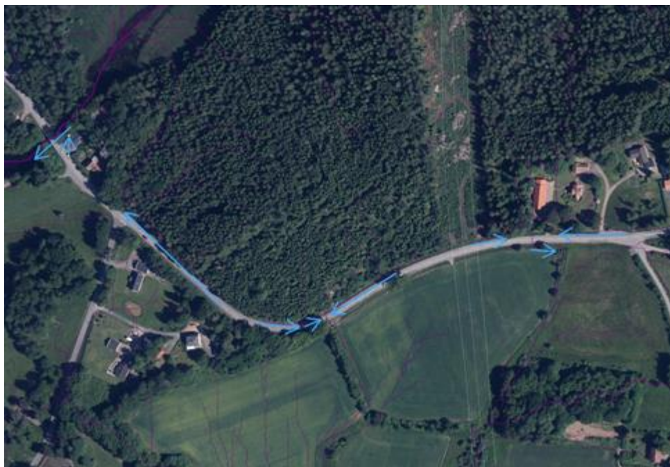
Figur 4.2-2. Avrinningsvägar och lågpunkter för väg 1968, (Scalگو Live, 2025)
