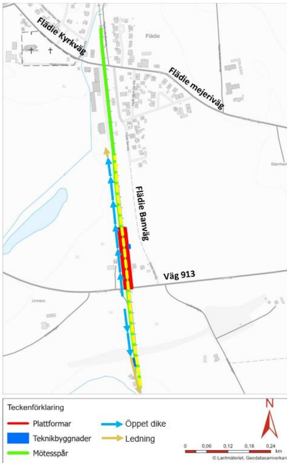
Figur 6 Principlösning för avvattning av det nya mötesspåret. Källa: Sweco.
