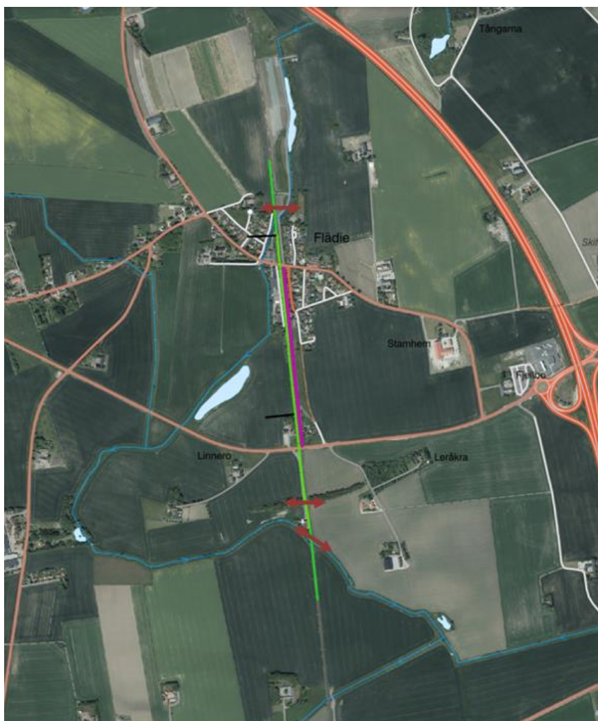
Figur 18. Figuren visar sträcka inom vilken passager för små- och medelstora däggdjur samt grod- och kräldjur av utretts (grönt streck). Rosa streck visar plats för befintligt staket mot spårspring. Troliga platser där djuren korsar spåret är angett med röda pilar. De anger inte exakt plats men i grönområdena där pilarna finns sker troligen passager.
