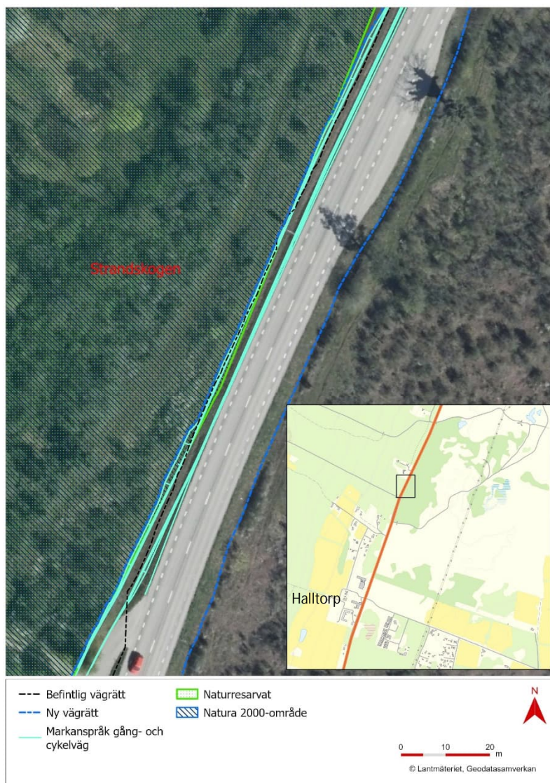
Figur 33. Intrång i Halltorps naturreservat i och med anläggning av gång- och cykelbana.
