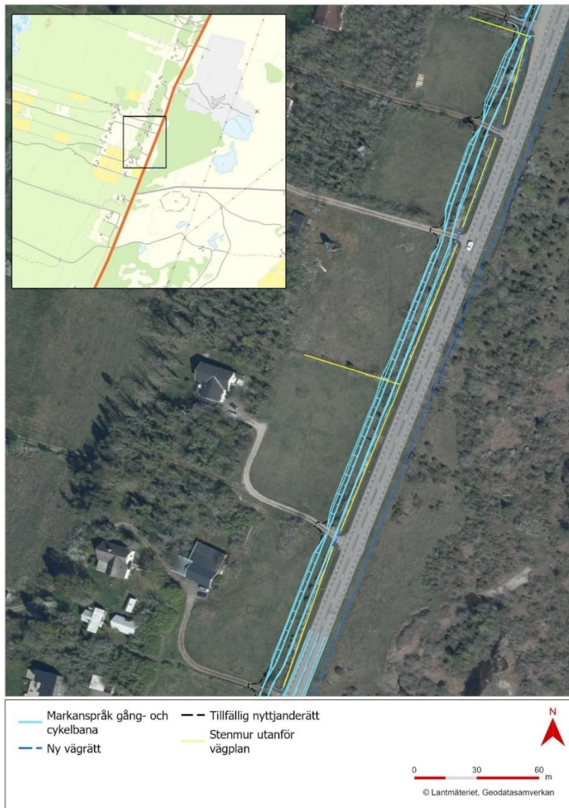
Figur 51. Stenmurar som inte omfattas av vägplan för vilka dispensansökan krävs. En ny, enskild väg planeras väster om den längsgående, biotopskyddade stenmur som följer den västra sidan av väg 136
