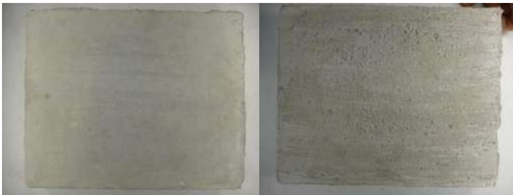
Figur 2. Betongytor. Fin betong till vänster och grov betong till höger.
