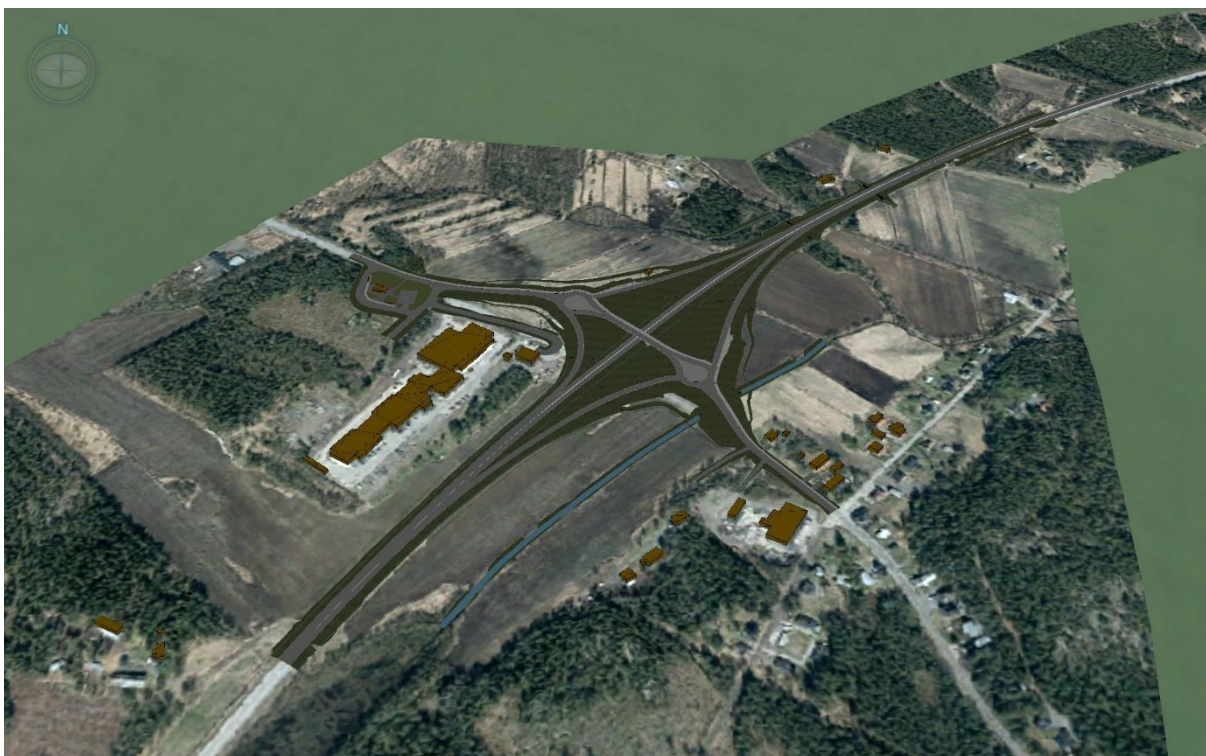
Figur 4.2–1 Översiktlig utformning av trafikplatsen med tillhörande busshållplats/bussvändslinga och pendlarparkering. Slänterna syns i mörkgrönt i anslutning till vägen.
